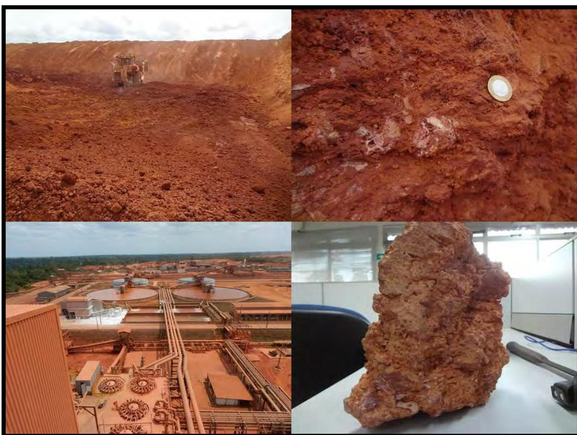
Figura 1. Acima à esquerda frente de lavra de bauxita com trator escarificando o minério BC (bauxita cristalizada); acima à direita o minério BC dominado por gibbsita microcristalina “granular” a compacta; abaixo à direita amostra de bauxita porosa, localmente preservando estruturas da rocha matriz (canto esquerdo inferior), do acervo do escritório da geologia da Hydro em Paragominas. Abaixo à esquerda visão geral do processamento da bauxita.
