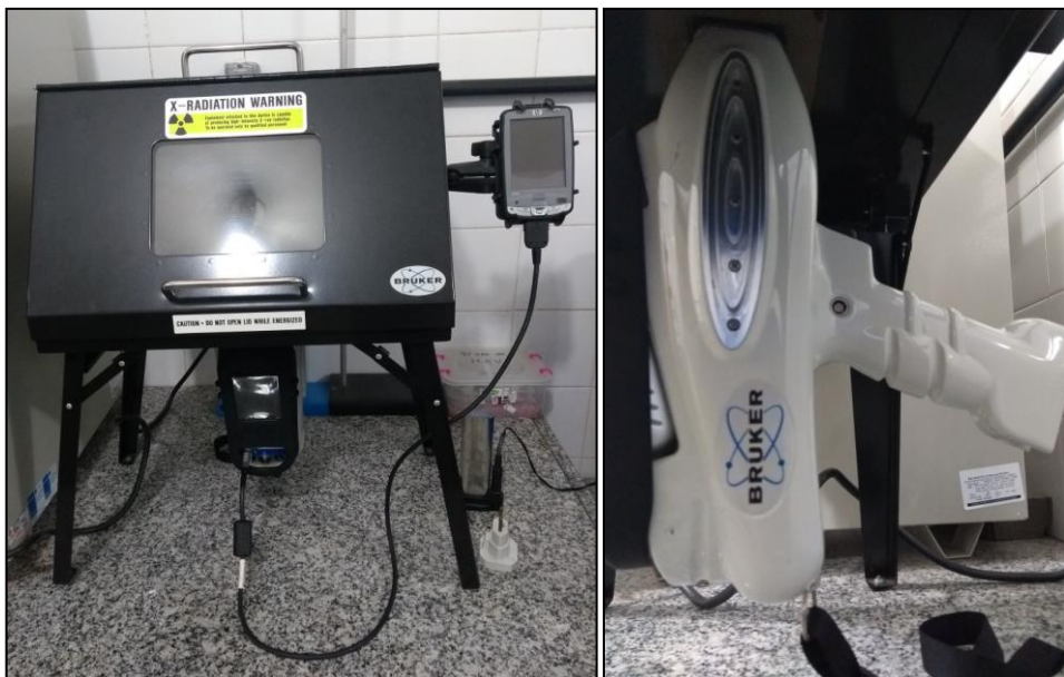
Figura 42. Espectrômetro por fluorescência de Raios-X portátil; marca e modelo: BRUKER/S1 TURBO SD ; financiador: 01.13.0144.00 277 FINEP/FNDCT; identificação FADESP: 9004.1.1.061014; projeto FADESP: 3369; análise: determinação multielementar semiquantitativa no intervalo de número atômico 11 a 92 (Na a U).
