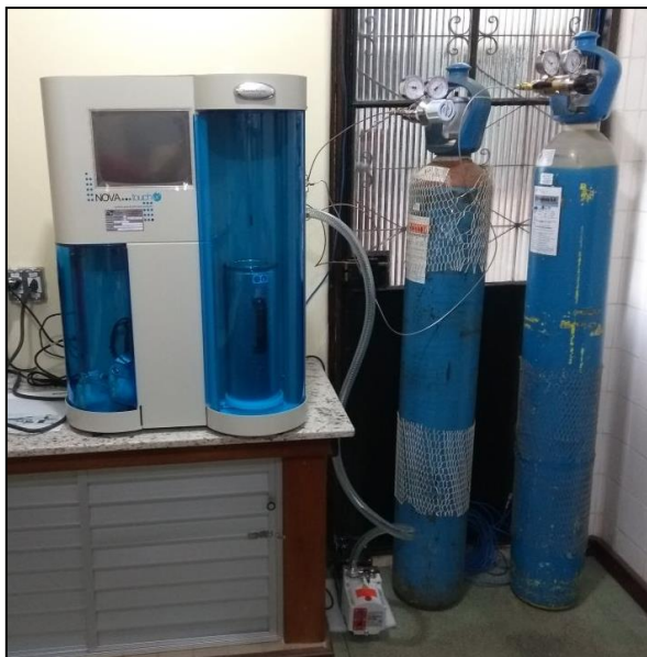
Figura 48. Análise de área superficial e tamanho de poro; marca e modelo: Quantachrome / Novatouche LX 3 .
