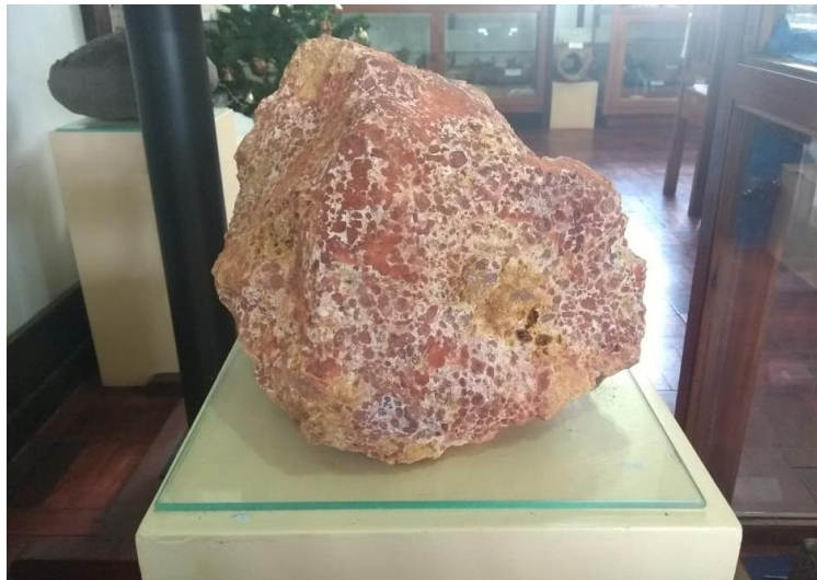
Fig. 20. Crosta ferruginosa fosfática laterítica.
