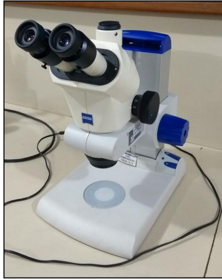
Figura 56. Estereomicroscópio; marca / modelo: Zeiss / AxioLab; análise: imageamento com aumento de até 20x.
