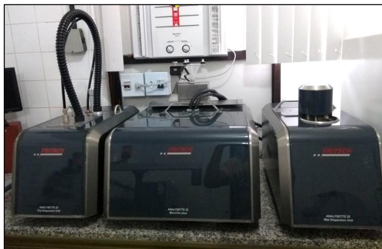
Figura 41. Analisador de partículas a laser; marca e modelo: FRITSCH/ ANALYSETTE 22; projeto: PRONEX e PRONEX-II; análise: determinação da distribuição granulométrica de partículas.
