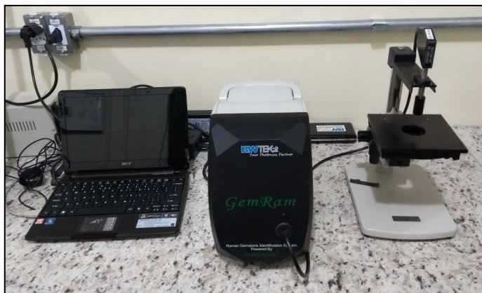
Figura 50. Espectrômetro \mu -RAMAN; marca e modelo: B&WTEK'S /GEMRAM™; financiador: Pró Equipamentos; tombamento Universidade Federal do Pará: 297.600; análise: identificação de gemas.
