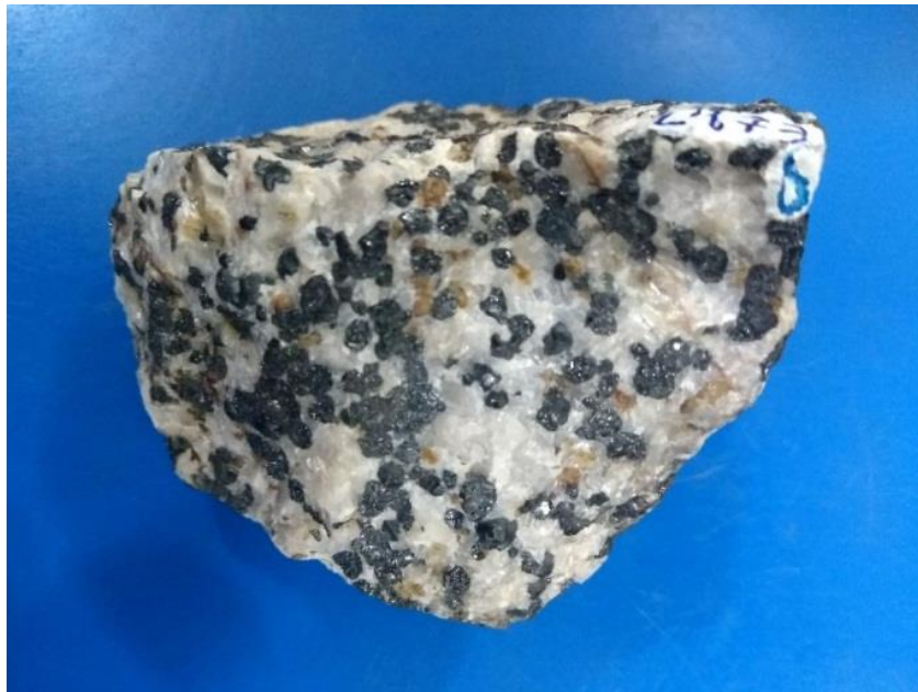
Figura 18. Franklinita com magnetita.
