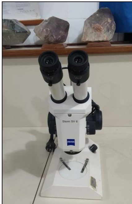
Figura 55. Estereomicroscópio; marca / modelo: Zeiss / Stemi V6 (cinco unidades); análise: imageamento com aumento de até 20x.
