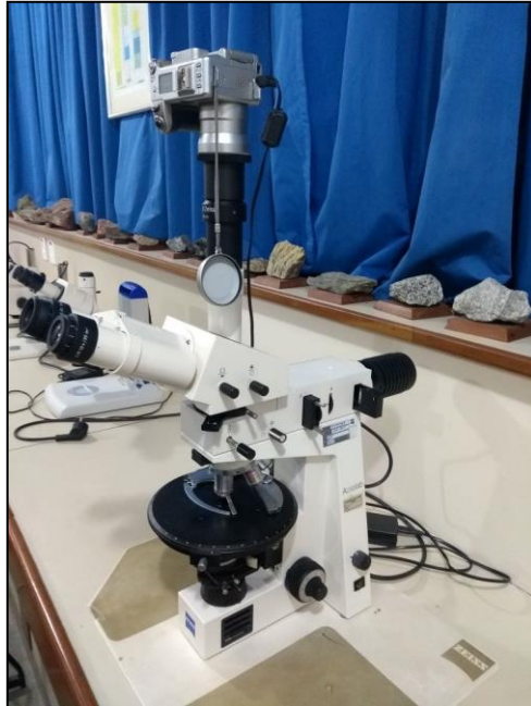
Figura 54. Microscópio petrográfico; marca / modelo: Zeiss / Axiolab; análise: imageamento com aumento de até 50x.
