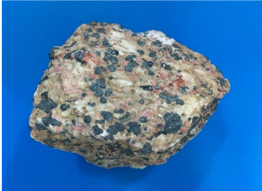
Figura 19. Titanomagnetita com wellenita.
