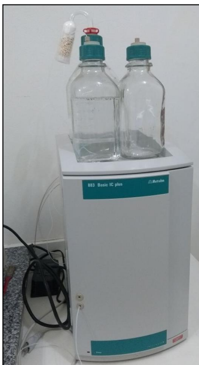
Figura 39. Cromatógrafo de íons; marca e modelo: Metrohm / 883 Basic IC Plus; tombamento Universidade Federal do Pará: 218.008; análise: determinação de ânions ou substâncias polares com ou sem supressão química, além de cátions.
