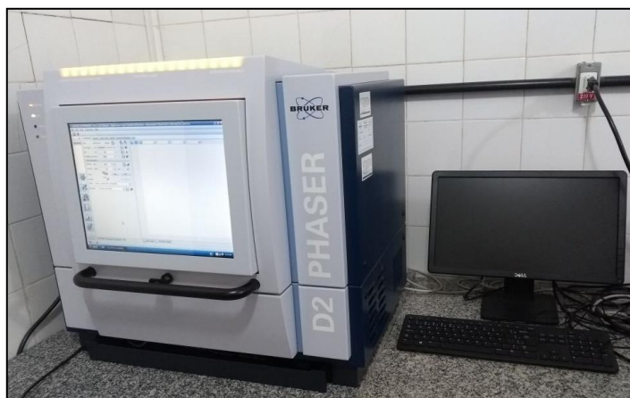
Figura 45. Difratorômetro de Raios-X; marca e modelo: BRUKER / D2 PHASER; financiador: 0110066400-0733/10 FINEP/FNDCT; identificação: 9004.2.1.271014; projeto FADESP: 2786; análise: identificação e caracterização de estruturas cristalinas.
