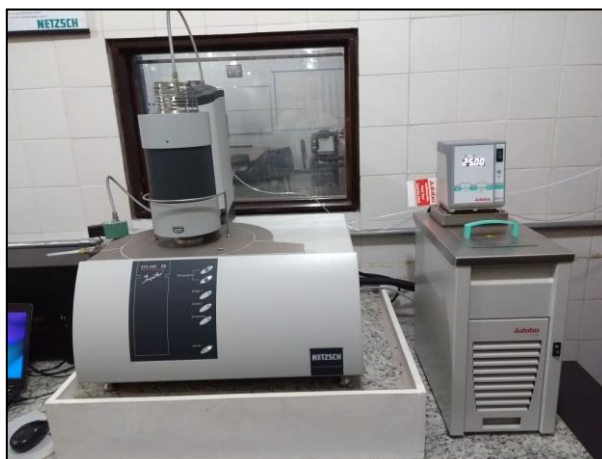
Figura 49. Equipamento de análise térmica; marca e modelo: NETZSCH / STA 449 F5 Jupiter; análise: determinação das transformações térmicas de materiais.
