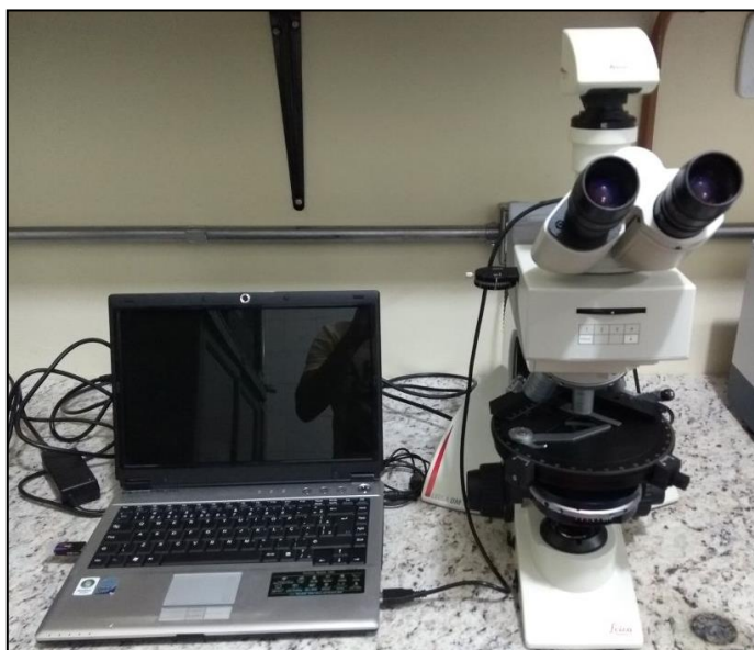
Figura 51. Microscópio petrográfico; marca / modelo: Leica / DM 2700 P; análise: imageamento com aumento de até 50x.
