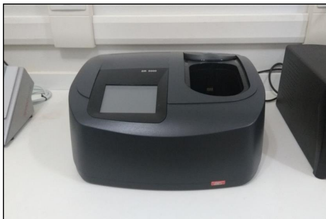
Figura 40. Cromatógrafo de íons; marca / modelo: Hach / DR 5000; tombamento Universidade Federal do Pará: 218.009; análise: análise multielementar a partir da medição da intensidade de radiação para cada comprimento de onda do espectro eletromagnético.
