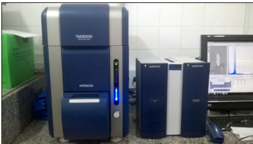
Figura 43. MEV de bancada com SED; marca e modelo: HITACHI/TM 3000; projeto: Pró Equipamentos; tombamento Universidade Federal do Pará: 249.777; análise: imageamento e determinação multielementar semiquantitativa.
