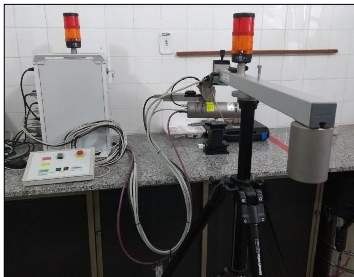
Figura 46. Espectrômetro \mu -FRX artax portátil; marca e modelo: BRUKER / ARTAX; análise: determinação multielementar semiquantitativa.
