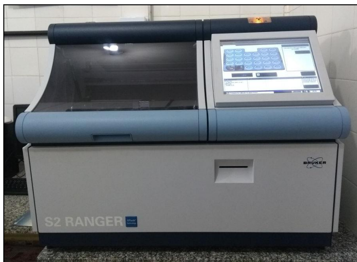
Figura 44. Espectrômetro de Raio-X de bancada; marca e modelo: BRUKER / S2 RANGER; financiador: 01.13.0144.00 277 FINEP/FNDCT; identificação: 9004.1.1.130415; projeto FADESP: 3369; análise: determinação e quantificação multielementar.
